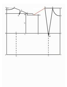
lci on répÃ"te la mesure pivotant que nous avons fait à l'étape 11 ("Step 11"), mais pour le épaule devant plutÃ't que pour l'épaule derriÃ"re. En se servant de la largeur de l'ÃPAULE, coller le point zéro de la rÃ"gle au point W, et faire pivoter la rÃ"gle autours de ce point jusqu'à ce qu'elle traverse la ligne de construction de l'étape précédente à une distance de la mesure du largeur d'ÃPAULE. Marquez ce point (point X).
