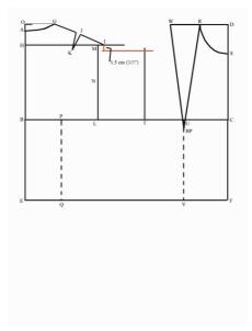
Examiner la ligne qui passe à travers le points H, M et I. Mesurer une distance de 1,5 cm (5/8") dessous cette ligne et inscrire à crayon leger une nouvelle ligne de construction à travers le
