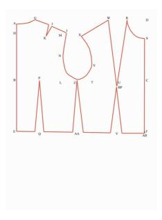
Tracer maintenant le contour du chemisier avec un crayon lourd et couper le long de ce contour pour produire le patron de base pour le chemisier.
