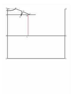
Faire une ligne verticale vers le haut,  $\tilde{A}$  partir du point L jusqu' $\tilde{A}$  l'intersection avec la ligne entre le point H et le point I, et marquez ce point d'intersection M.  $\tilde{A}$ ' noter que cette ligne est une autre ligne de construction qui ne figure pas dans le contour final du patron - alors servez-vous d'un crayon  $\tilde{A}$  mine  $I\tilde{A}$ ©ger pour la dessiner.
