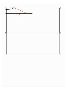
Maintenant, trouver et marquer le point à mi-distance entre G et I le long de la ligne de l'épaule - il s'agit tu point J. Du point J, mesurer une distance de 5 cm (ou 2") vers le bas, et 1 cm (3/8") vers la gauche. Marquer ce point (point K) - il s'agit du bout de la pince de l'épaule derriÃ"re.
